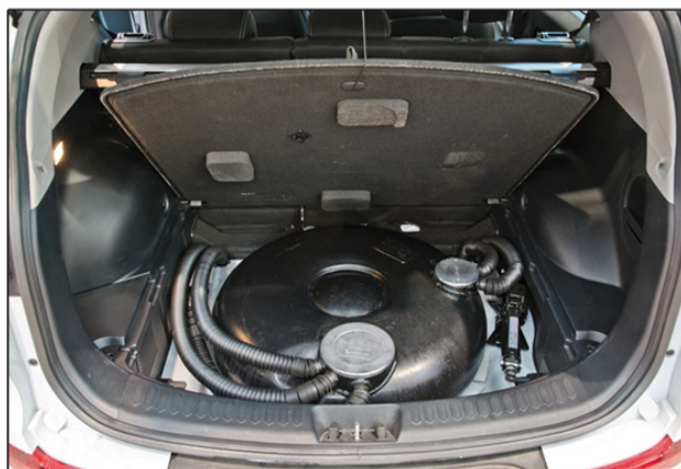
System LPG DIRECT INJECTION zamontowany w KIA Sportage 1.6 GDI
